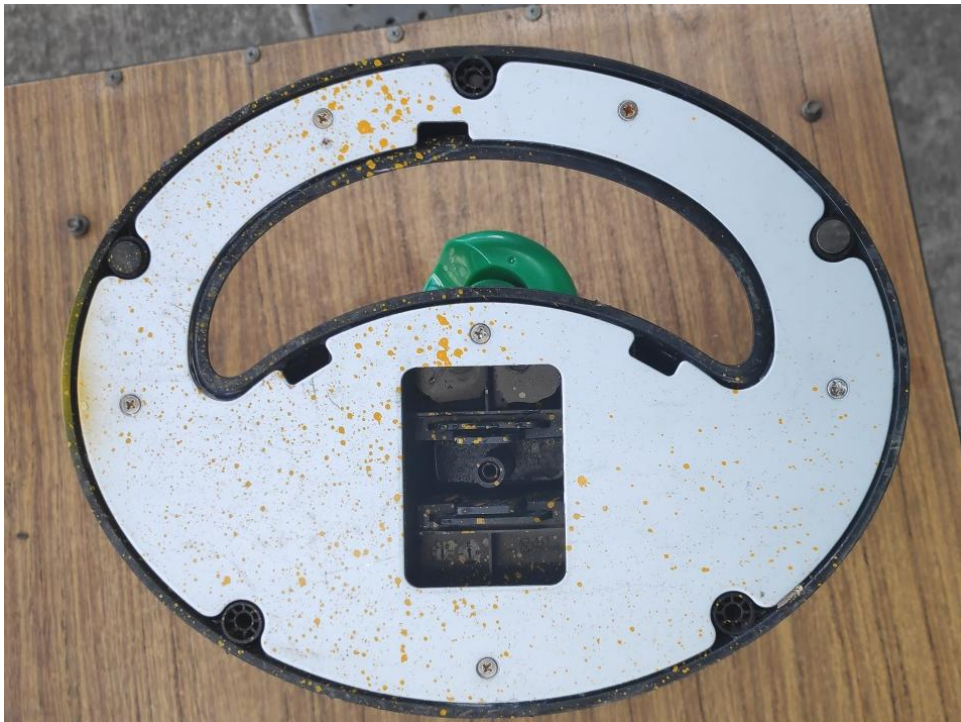
圖 5.1.1-6 電腦液晶螢幕底座之大尺寸補強鐵板
